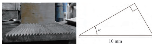
图 1 钢制模具图及锯齿示意图
